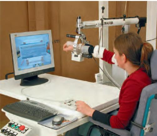
**Abb. 13.12** Robot-mediated therapy system, GENTLE/S (Coote u. Stokes 2003). Mit freundlicher Genehmigung von GENTLE/S system at University of Ljubljana, 2001
